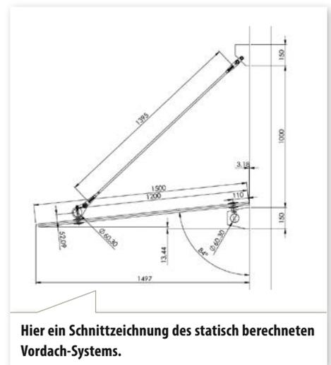
Hier ein Schnittzeichnung des statisch berechneten Vordach-Systems.
